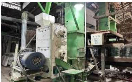
Tahap. 3 Beras yang sudah terpisah dari padi dimasukkan ke dalam mesin polish batu untuk mengupas kulit dari beras
