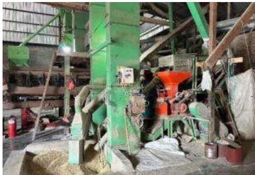
Tahap. 1 Padi kering yang ada dilubang pecah dimasukkan ke mesin pecah kulit melalui alifator
